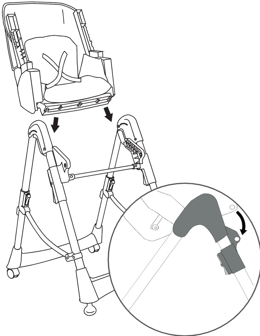
Tout en gardant les repères positionnés comme indiqué à l'étape précédente. Emboîter le siège **(C)** dans les encoches blanches situées sur le haut de l'armature.
