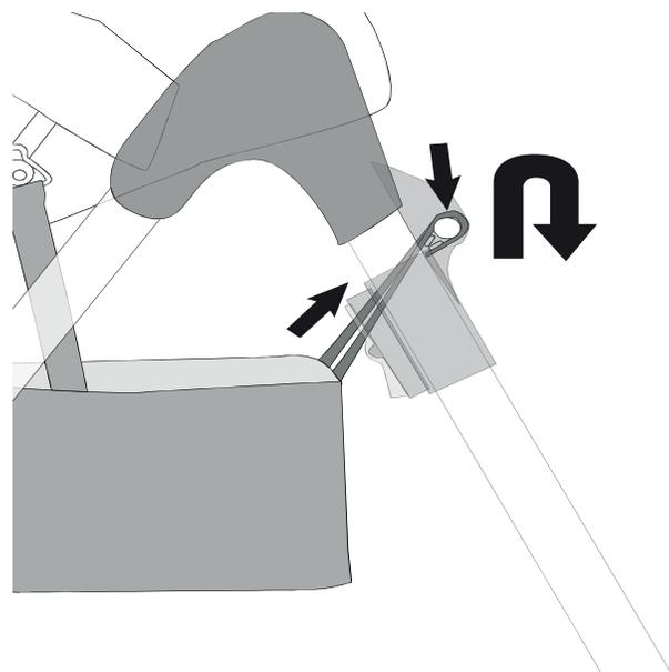
Accrocher le panier **(F)** sur les supports situés à l'arrière du siège.
