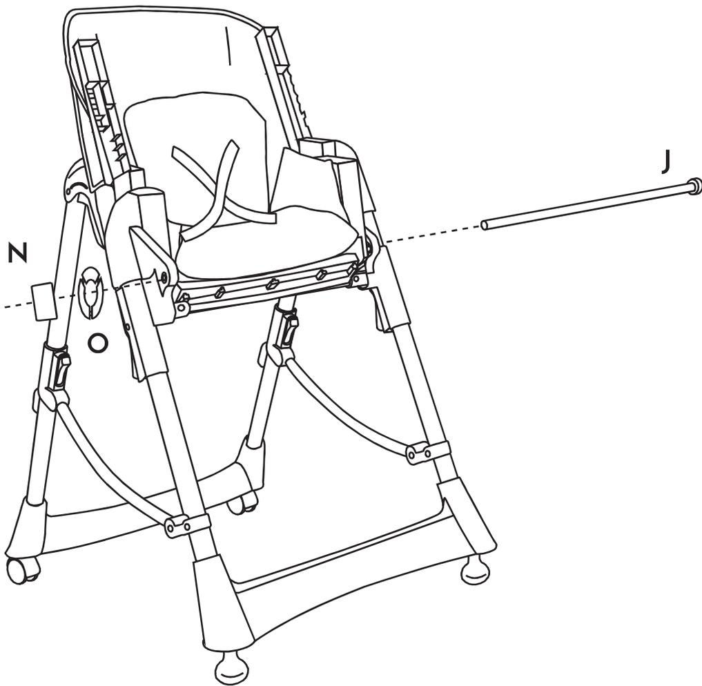
Glisser la barre de blocage **(J)** d'un côté à l'autre du siège en suivant la glissière située en dessous.
