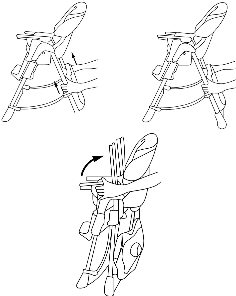
Se placer derrière la chaise et appuyer sur les deux boutons rouges situés de chaque côté du châssis.
