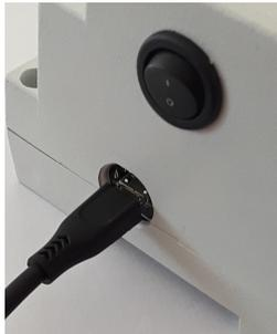
Una vez cargada el software, debe quitar el cable USB y el interruptor debe regresar en la posición 'I' para que el equipo se reinicie.
