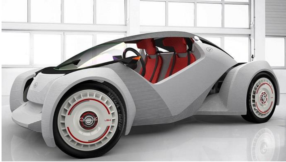
شكل 10.2 سيارة ستراتي Strati المنتجة بالطباعة الثلاثية
