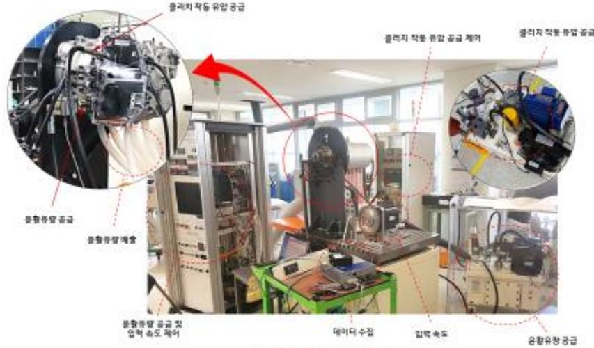
그림 1. 습식 DCT 윤활유량 측정 시험 장치
