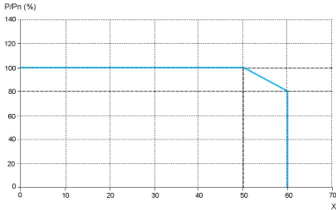
X Température de fonctionnement maximale (°C)
