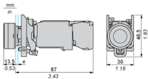
e : épaisseur du dispositif de serrage : 1 à 6 mm / 0,04 à 0,24 pouce
