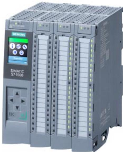
SIMATIC S7-1500 CPU compacte CPU 1512C-1 PN, unité centrale avec mémoire de travail 250 ko pour programme et 1 Mo pour données, 32 entrées TOR, 32 sorties TOR, 5 entrées analogiques, 2 sorties analogiques, 6 compteurs rapides, 4 sorties rapides pour PTO/PWM/sortie fréquence 1re interface: PROFINET IRT avec commut. 2 ports, 48 ns performance sur bit, incl. Connect. frontal push-in, SIMATIC Memory Card requise
