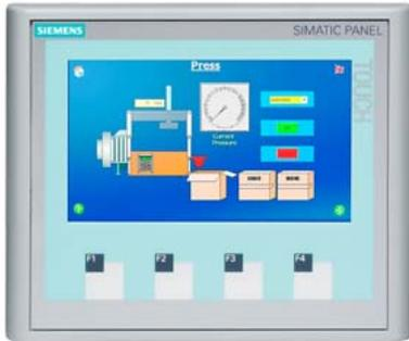
SIMATIC HMI KTP400 Basic Color PN, Basic Panel, Commande par touches/tactile, écran TFT large 4", 256 couleurs, interface PROFINET, configurable à partir de WinCC Basic V11 SP2/ STEP 7 Basic V11 SP2, contient un logiciel en open source, qui est est cédé à titre gratuit voir CD joint
