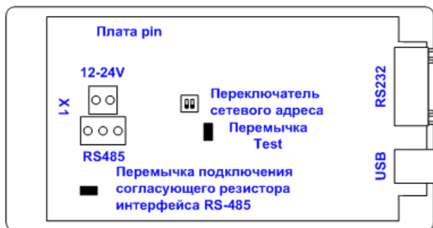
Расположение внутренних элементов ПИН.
