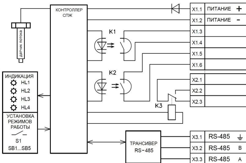
Примечание - В СПЖ «Стрим» V4 отсутствуют трансивер RS-485, клеммы для подключения цифрового интерфейса, переключатель S1 и индикатор HL4.
