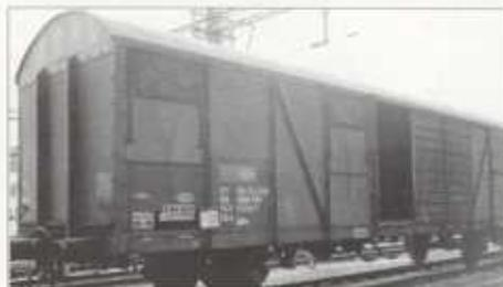
Zweiachsiger gedeckter Wagen Gbs. Diese Wagen werden bei den SBB bis auf einen Restbestand laufend ausrangiert. Sie werden z.T. als X-Wagen weiterverwendet oder an die SNCF dauervermietet. (Ostermündigen, Mai 1993)
