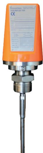
A gama de cobertura de produtos Reflex VF de TDR (reflectometria no domínio do tempo) é o ideal para a medição de líquidos, pós e granulados até uma faixa 24m. Estes não são afetados por pressão, temperatura, viscosidade, vácuo, espuma, poeira, alterações da constante do dielétrico ou a impregnação da sonda, a série VF pode virtualmente medir qualquer produto utilizando uma dos seus sete tipos de sonda.
