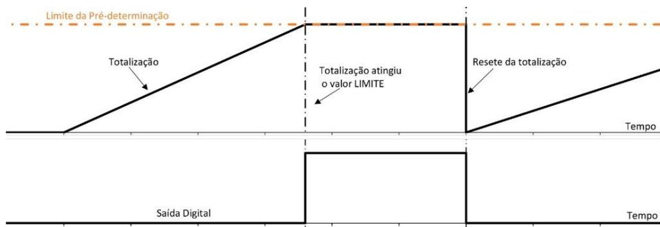
*Figura 13 - Funcionamento da pré-determinação com reset manual*
