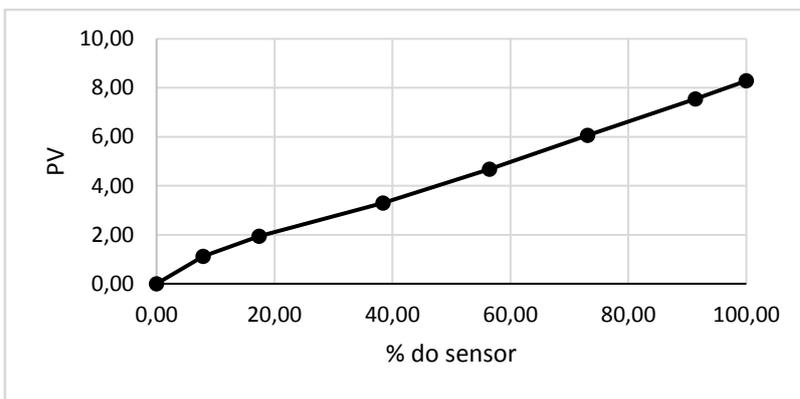
Quando o sensor envia um sinal linearizado, basta configurar a escala mínima e máxima do PV (Variável de Processo) associada ao mínimo e máximo valor do sinal. Por exemplo:
