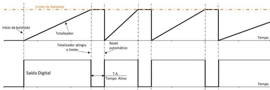
*Figura 12 - Funcionamento da batelada com reset automático.*
