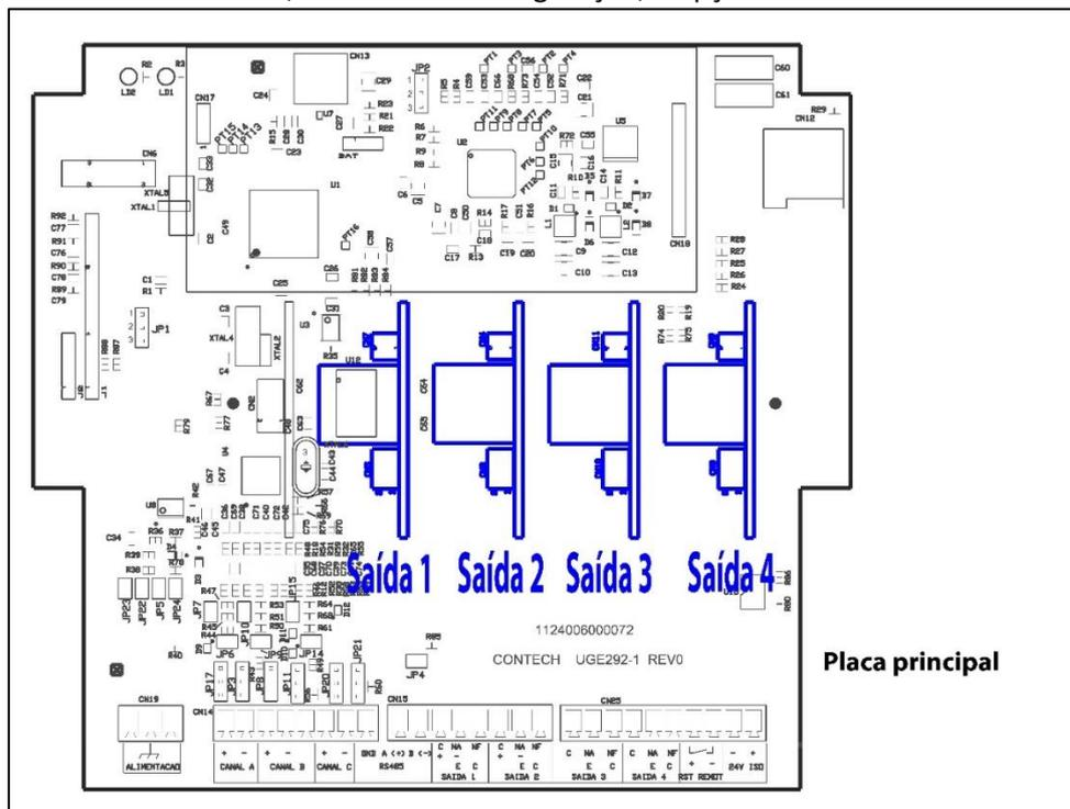
Figura 6 – Localização dos conectores dos Módulos de Saída
