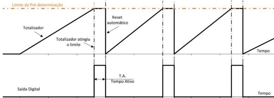
*Figura 14- Funcionamento da pré-determinação com reset automático*
