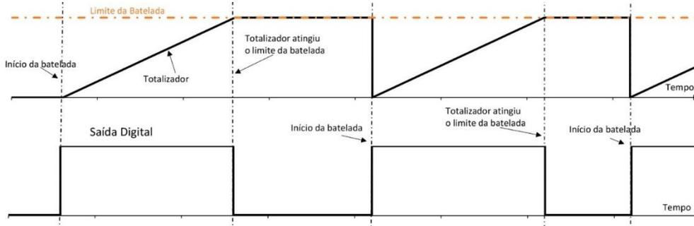
*Figura 11 - Funcionamento da batelada com reset manual.*
