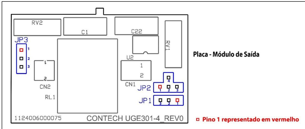
Figura 7 - Posicionamento dos jumpers no Módulo de saída
