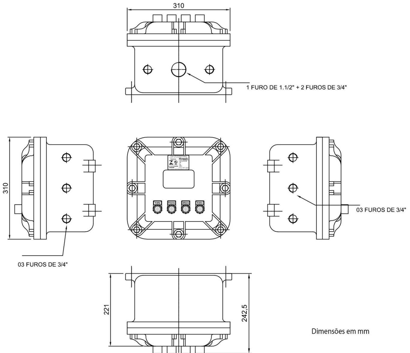
*Figura 4 – Dimensões versão à prova de explosão*
