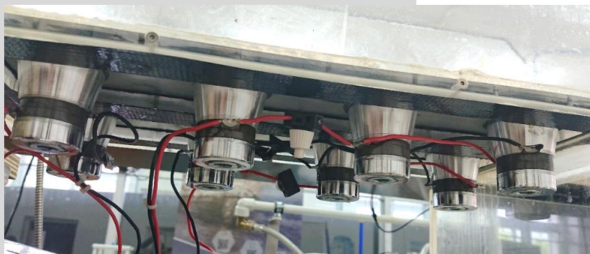
Sl. 4 Položaj UZ pretvarača s donje strane reaktora
