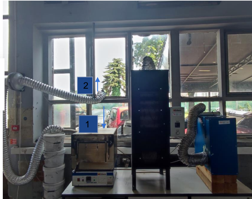
Spaljivanje mulja u laboratorijskoj peći za žarenje
