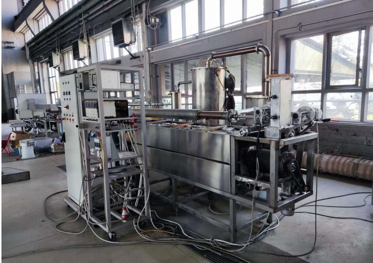
Pilot postrojenje za uplinjavanje (IndeLoop)
