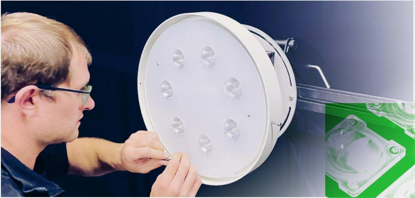
Leuchtenprototyp bei der lichttechnischen Vermessung.
