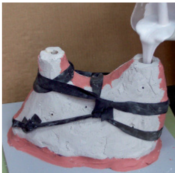
Fig. 422. Colada de silicona para realizar un molde flexible.
