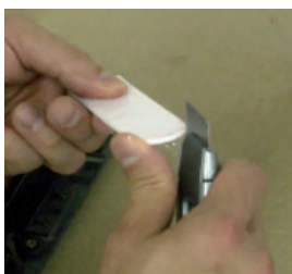
Fig. 326. Limpieza de una rebaba del plástico con cúter.
