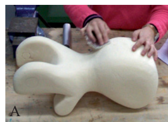
Fig. 501. Desbastar parte del volumen de un bloque se puede realizar con la sierra térmica, pero algunas veces es más cómodo e instantáneo hacerlo con sierras o cúter, independientemente del tipo de espuma que trabajemos.
