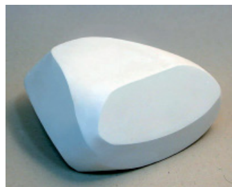
Fig. 485. Las espumas rígidas sirven, sobre todo, para desarrollar volúmenes variados y complejos, desde formas orgánicas a formas más geométricas. Modelo de radiodespertador. Diseño de Nicolás Oliva (2003).
