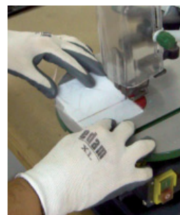
Fig. 325. Si se tiene la opción de utilizar una sierra mecánica, cortar el plástico es una tarea más fácil siempre que se haga con cuidado.
