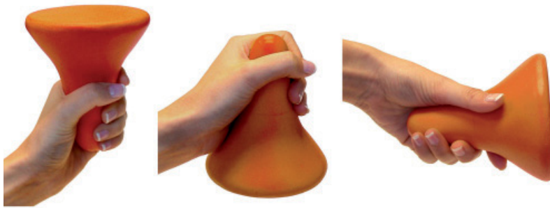
Fig. 172. Análisis de distintas maneras de coger o sujetar un determinado objeto con la mano, con el fin de verificar factores ergonómicos.
