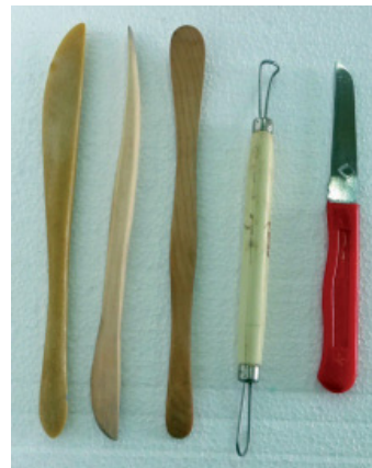
Fig. 389. Utensilios básicos para el modelado: palillos variados, vaciador y cuchillo de hoja lisa.
