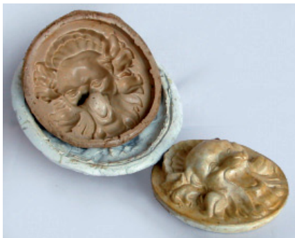
Fig. 424. Los moldes flexibles necesitan casi siempre un contramolde rígido que mantenga su forma. En la imagen, el molde flexible, el contramolde de escayola y el modelo original.
