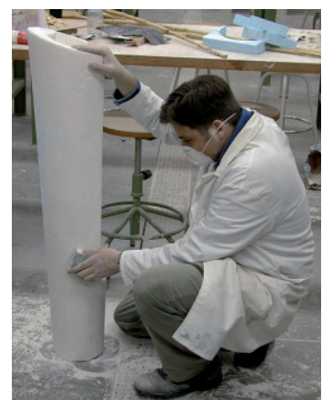
Fig. 237. Proceso sustractivo en la elaboración de un modelo a escala de fuente para beber, realizado con espuma de poliestireno. Diseño de Marcos Gómez (1999).
