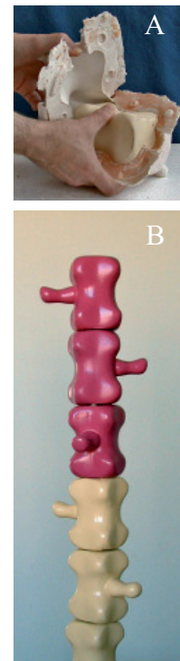
Fig. 467. Los moldes de silicona reproducen fielmente los volúmenes y las superficies de los objetos y permiten la extracción de numerosas copias con cualquier material sin problemas (A). Perchero modular de pie, realizado con resina de poliéster tintada (B). Diseño de Sofía Saborido (1999).
