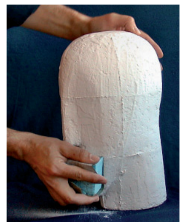
Fig. 517. Una vez seca la masilla, se lija para igualar las superficies.
