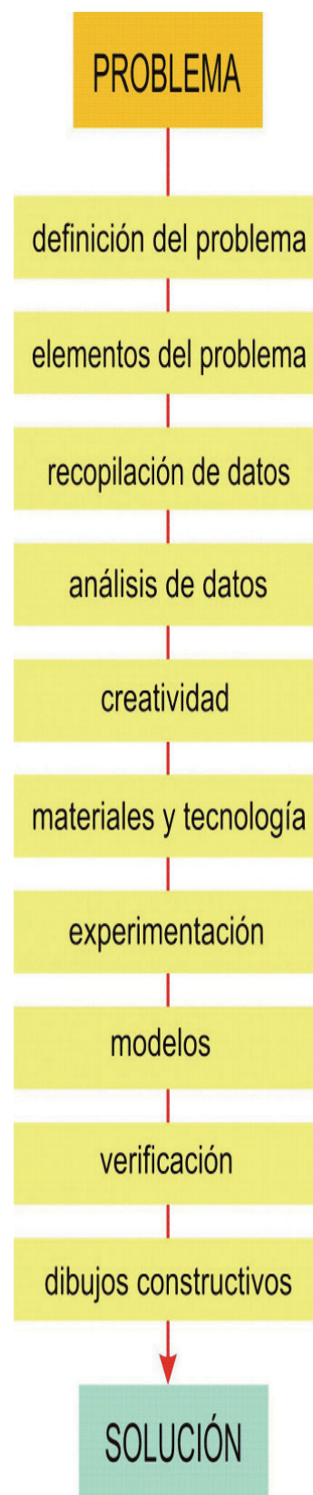
Fig. 186. Esquema del método proyectivo según Bruno Munari (del libro ¿Cómo nacen los objetos? ).
