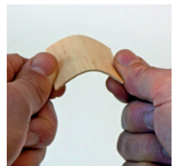
Fig. 342. Las láminas finas de madera de balsa se pueden curvar en dirección perpendicular a la orientación de la fibra.
