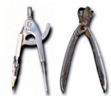
Fig. 210. Primitivo compás con adaptador de lápiz y regulador de radios.
