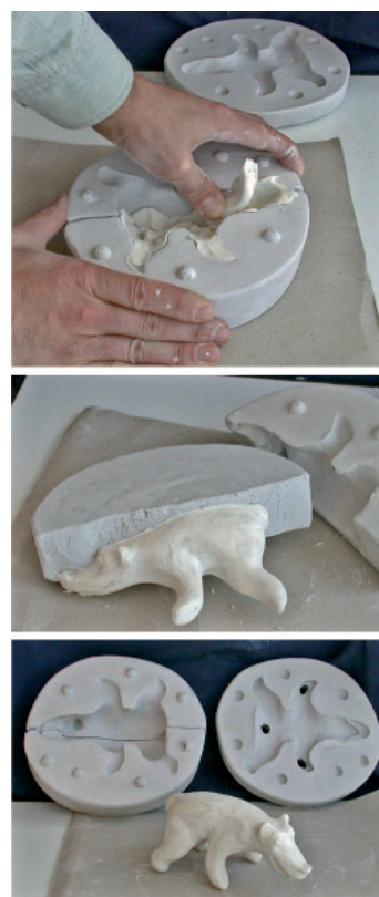
Fig. 455. Reproducción por apretón de un personaje de animación de plastilina sobre los moldes de escayola, previamente espolvoreados con talco. Después se deben retocar las rebabas y las grietas que puedan formarse.
