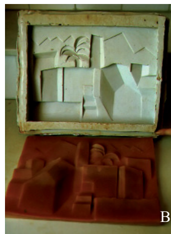
Fig. 459. Sobre el molde humedecido del relieve se vierte la cera fundida al baño maría (A) y cuando se enfría se puede ver rápidamente el resultado (B).
