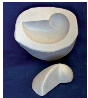
Fig. 442. Resultado del molde en bloque de un modelo de plastilina.
