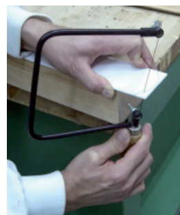
Fig. 324. La sierra de marquetería también es útil para cortar láminas finas de plástico.
