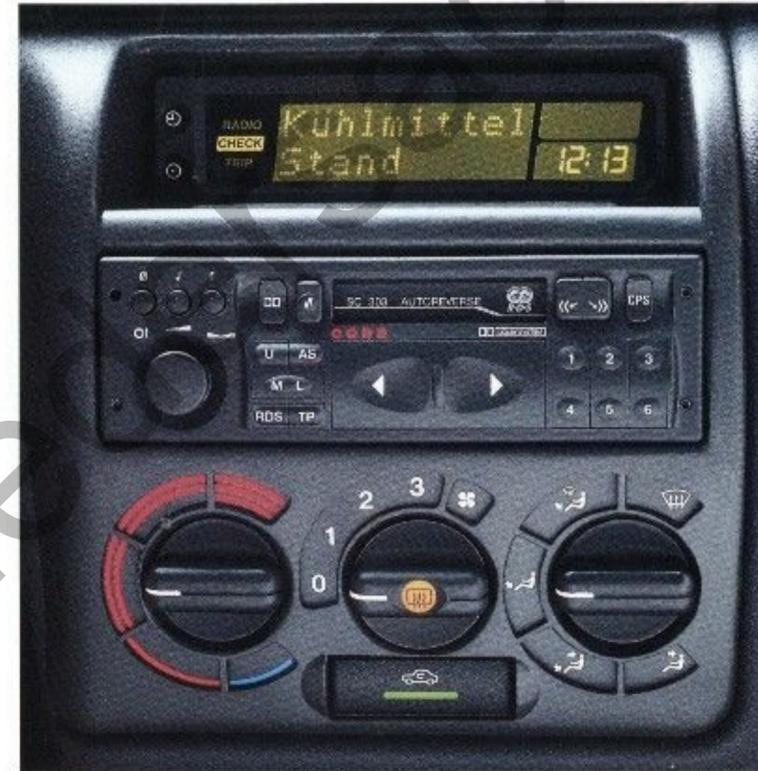
Die Informationszentrale im Astra GSi 16V. Das Multi-Info-Display. Es zeigt wichtige Funktionen des Opel Check-Control-Systems, des Bordcomputers und natürlich die Radiofunktionen. Wichtige Hinweise werden auch bei eingeschaltetem Radio und Bordcomputer eingeblendet. Besonders wichtige Hinweise schalten sich alle 15 Minuten automatisch wieder ein.
