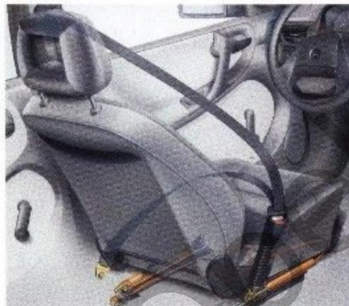
und einer Sitzrampe in allen Sitzen (hinten nur in den Limousinen). Bei einem Frontalaufprall zieht der Gurt-schloßstraffer den Gurt sofort stramm, reduziert also weitgehend die sogenannte Gurtlose. Die Gefahr eines Kopfaufpralls auf Lenkrad oder Instrumententafel wird damit wesentlich herab-gesetzt.
