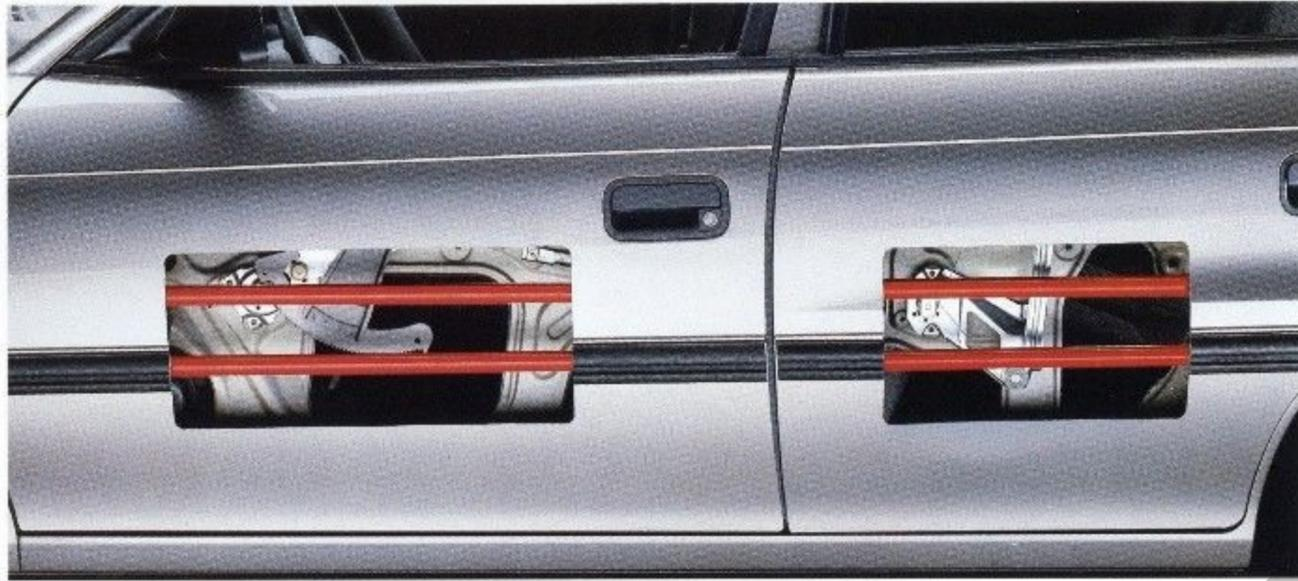
Die integrierte Doppel-Stahlrohrverstärkung in den Seitentüren sorgt für verbesserten Insassenschutz bei seitlichen Kollisionen.
