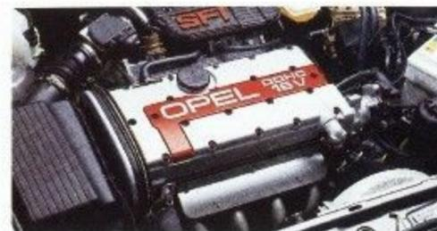
Das 2.0i-16V-Triebwerk mit 110 kW (150 PS).
