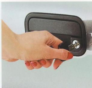
Der praktische Dreh: Die Zentralverriegelung verschließt Türen, Tankdeckel und Kofferraum.
