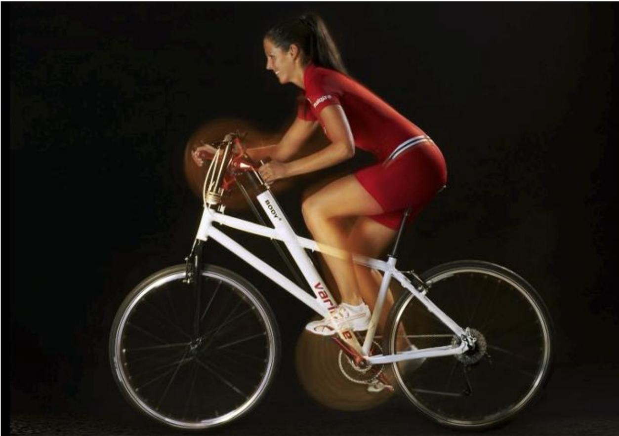
Wissenschaftlich ist das System Arm- und Beinkurbeln auch schon angegangen worden. Eine Studie der New Mexico State University attestierte einem solchem Rad bei Tests an jungen Erwachsenen mit durchschnittlich athletischen Fähigkeiten, dass die maximale Leistung bei Arm-Bein-Kurbel Systemen im Vergleich mit einfachen Beinkurbeln um mehr als 30% erhöht werden konnte. Darüber hinaus wurde beim Arm-und Bein-Kurbel Einsatz eine höhere Effektivität bei der Dauerleistungsabgabe ermittelt.
