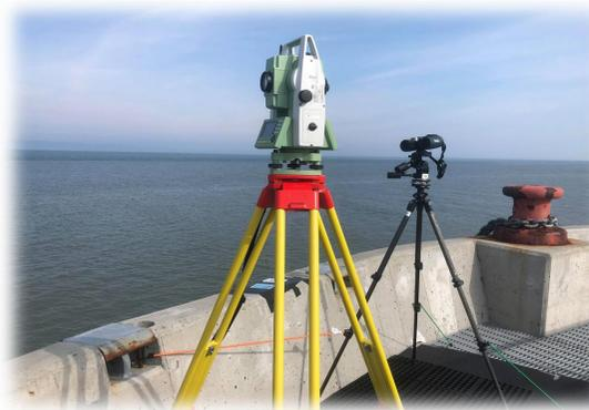
Figure 2. Matériel utilisé pour effectuer les observations terrestres (station totale et jumelles fixées sur un trépied).
