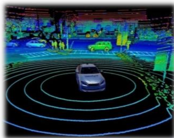
הדמייה של סריקת השטח סביב הרכב, באמצעות חישן Lidar.
