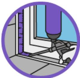
Usado para instalar quadros de portas e janelas, isolamento e fixação de canos e condutas de ar condicionado, enchimento de furos e aberturas, bem como para isolamento sonoro e térmico. Isolamento de tubos e cabos eléctricos.
