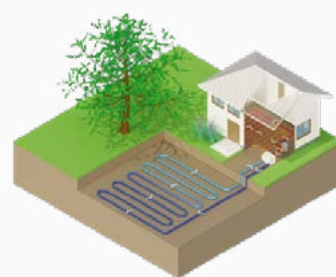
Pompe à chaleur sur capteurs enterrés horizontaux
