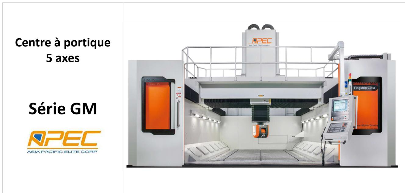
Le centre d'usinage 5 axes APEC série GM est une machine très dynamique pour l'usinage de pièces complexes et de grandes dimensions. Ces machines sont destinées principalement pour l'usinage de structure aéronautique en aluminium ou des moules et outils aux formes complexes.
