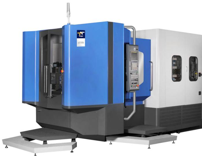
Le centre d'usinage horizontal 4 axes TONGTAI série HA-II est une machine universelle conçue pour l'usinage de pièces en aluminium, fonte et aciers. Elle est dotée d'un palettiseur 2 palettes pour le chargement d'une pièce en manuel ou automatique pendant l'usinage d'une autre pièce. La série HA-II propose des déplacements rapides jusqu'à 60m/min, et un changeur d'outils entraîné par came à rouleaux afin de réduire les temps de cycles.
