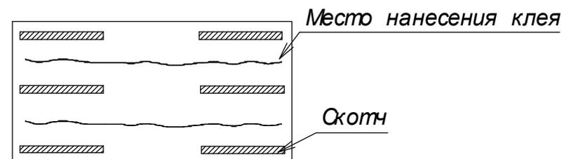
Схема нанесения клея на зеркало (Сх.2)
