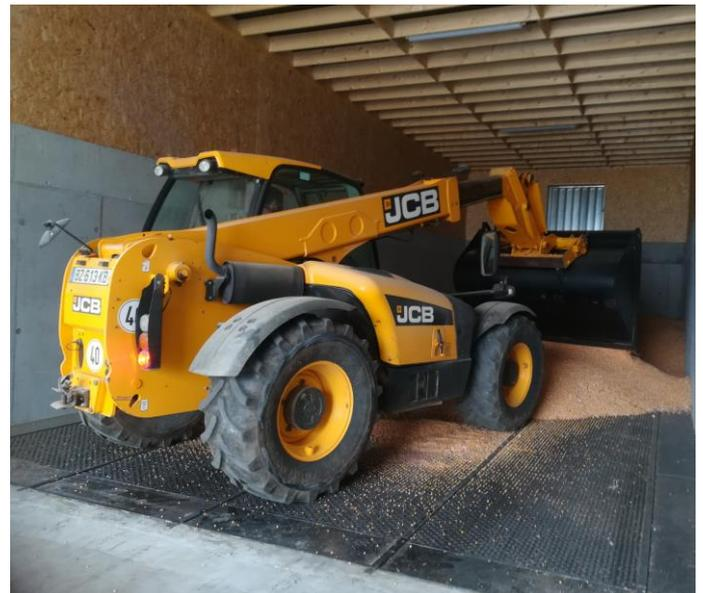
Remplissage d'une case de séchage à plat en maïs grain
