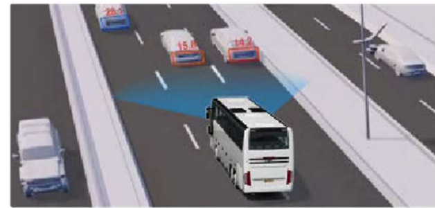
Alerta de distancia insuficiente de frenado. (FCW, Forward Collision Warning)
