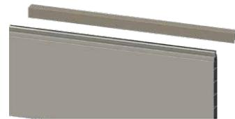
**ÉTAPE 10** Insérer un U réducteur dans le poteau pour compenser l'épaisseur du panneau (24 mm). Glisser les panneaux d'un seul tenant à l'intérieur des poteaux en laissant un jeu de 5 mm de chaque côté
