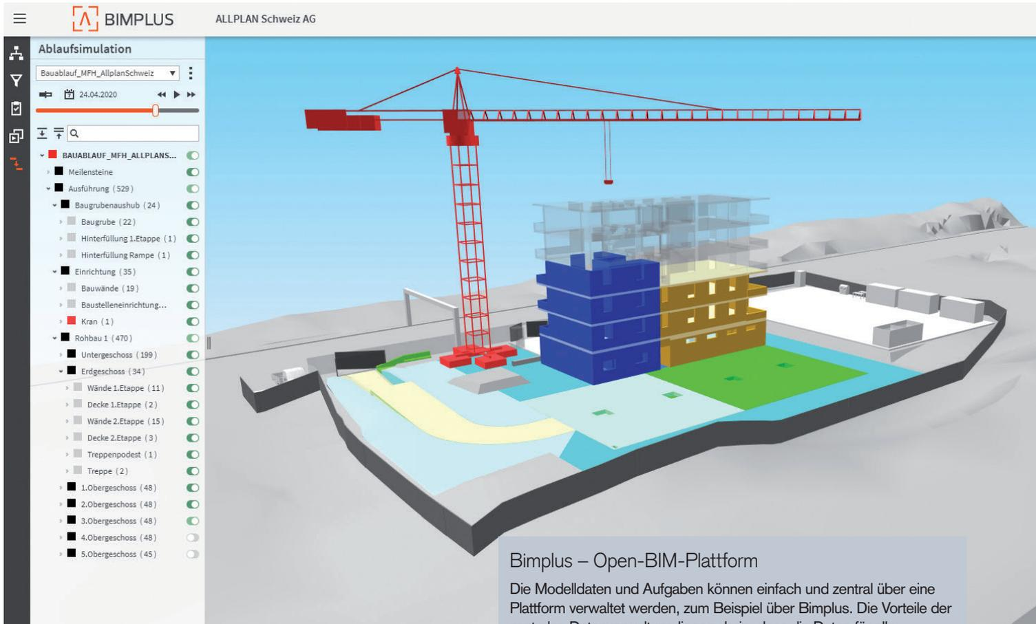
**Bauablaufsimulation – open BIM Plattform Bimplus**
